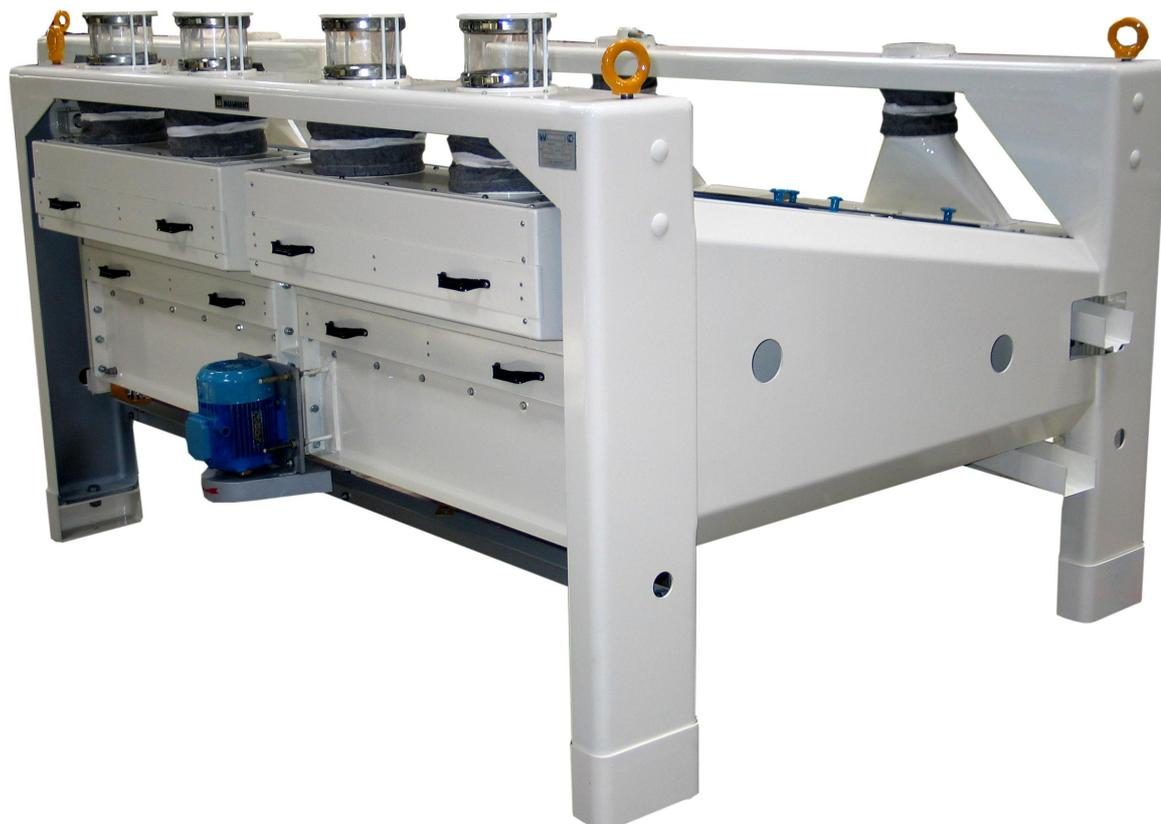
*Сепаратор зерноочистительный А1-БИС-100 предназначен для отделения от зерна пшеницы примесей, отличающихся от него шириной, толщиной и аэродинамическими свойствами.*
